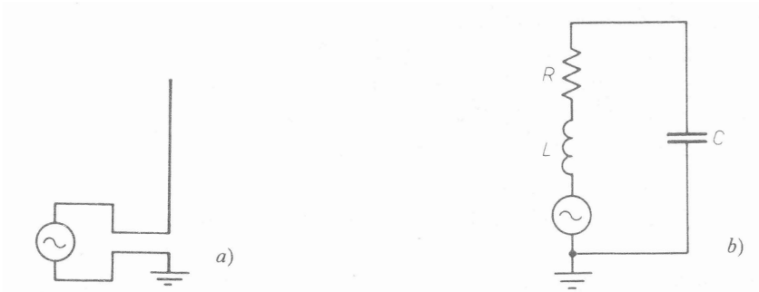
Fig. 11.5 - a) Dipolo marconiano; b) circuito risonante equivalente al dipolo marconiano.
